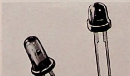
Weitwinkel-Leuchtdioden, links im Standard – rechts in platzsparender Ausführung. (OPCOA)
